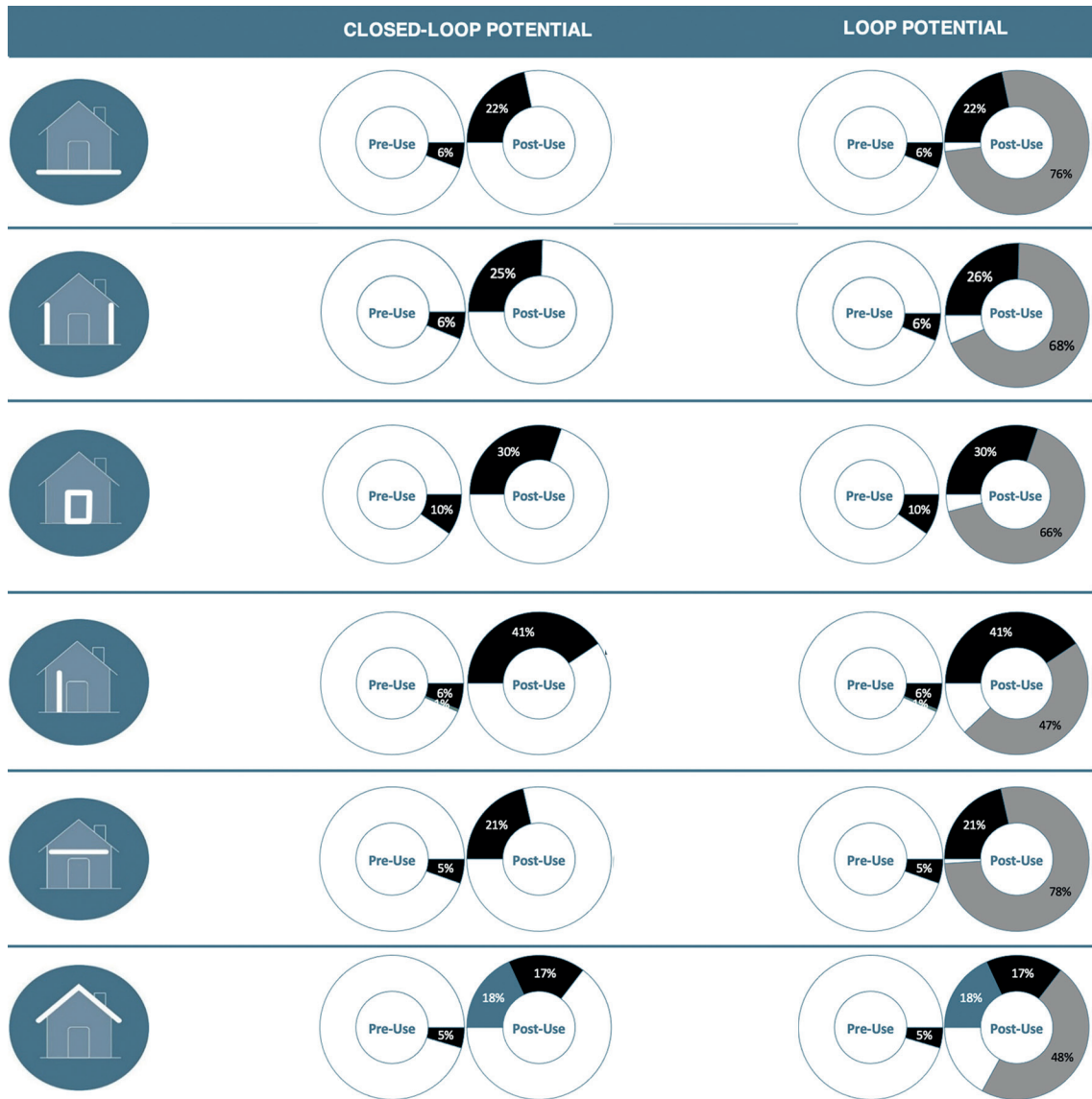
Abbildung 46 Ergebnisse des Kreislaufpotenzials der Konstruktion, unterteilt in die Bauteilgruppen der Konstruktionsvariante 3, Darstellung aus dem UMI-Tool von Anja Rosen
