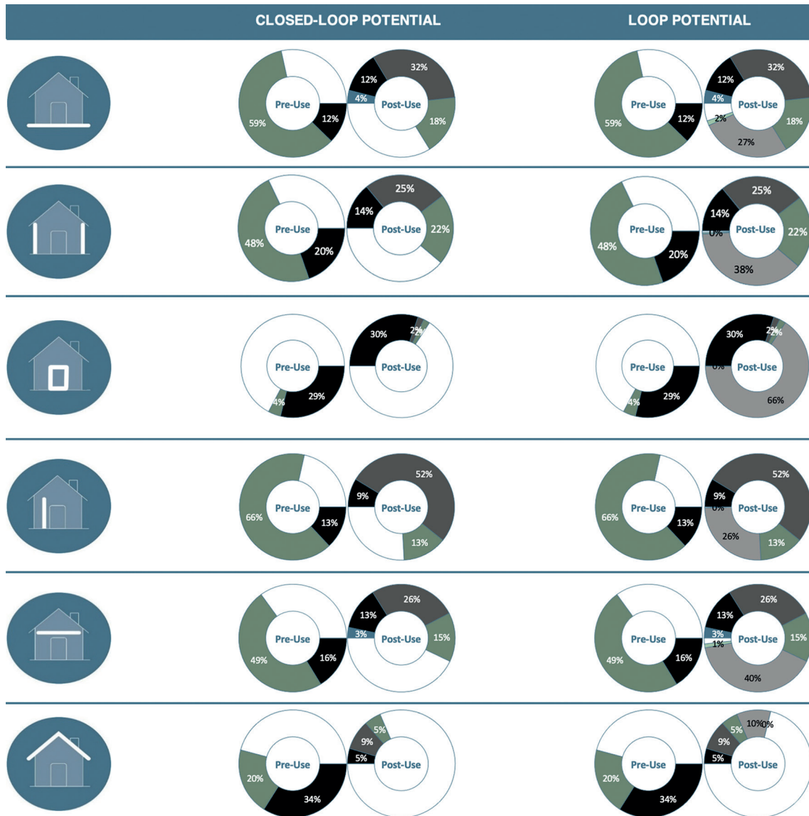
Abbildung 44 Ergebnisse des Kreislaufpotenzials der Konstruktion, unterteilt in die Bauteilgruppen der Konstruktionsvariante 2, Darstellung aus dem UMI-Tool von Anja Rosen
